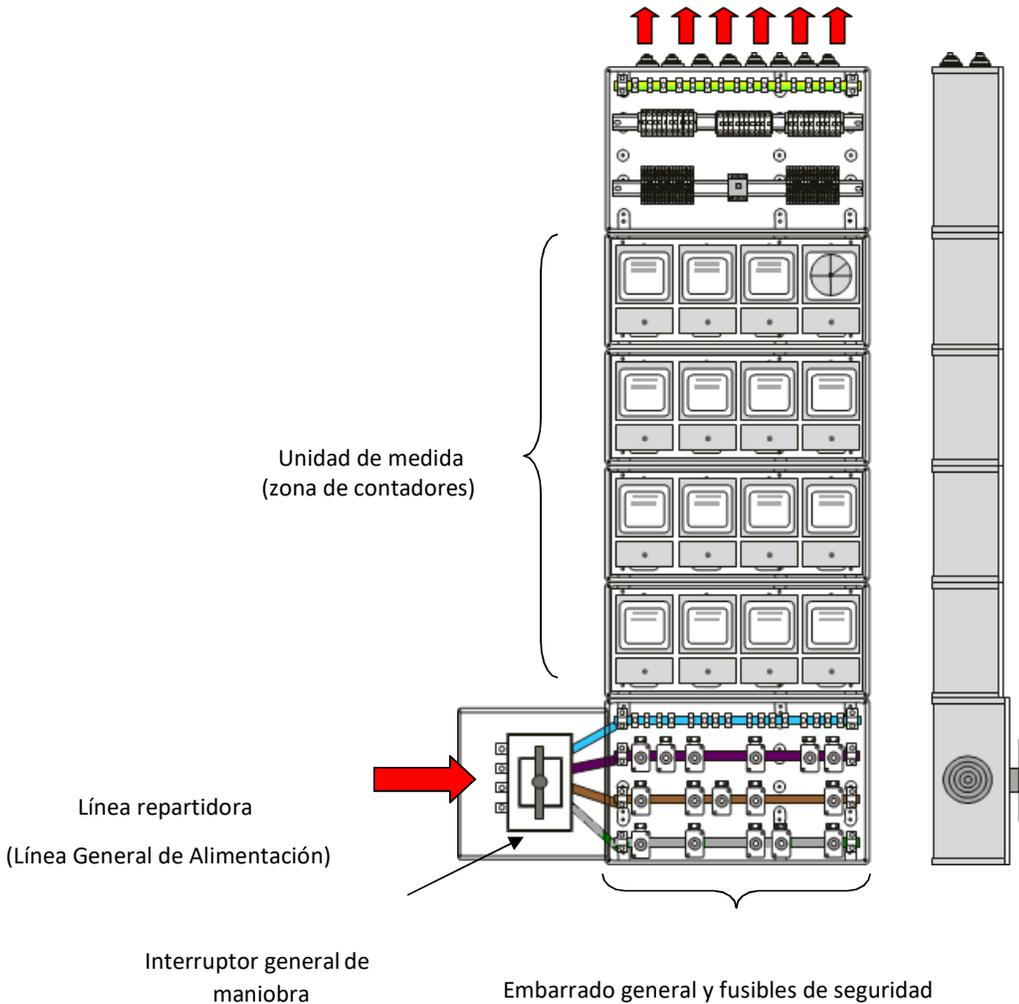
**NOTA:** En el caso de suministro a un solo usuario (viviendas unifamiliares), la Caja General de Protección (CGP) y el equipo de medida de consumo eléctrico (contador) se integran en un elemento común llamado “Caja de Protección y Medida (CPM)”, que engloba el contador y los fusibles de protección en un solo elemento. En estos casos la línea repartidora, que enlazaba la CGP y la centralización, desaparece.
