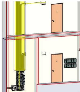
El Interruptor de Control de Potencia (también llamado ICP o limitador) es un interruptor que instala la compañía eléctrica. Sirve para limitar el consumo de energía del cliente a la potencia que se ha contratado. Se conecta a los conductores que llegan de la Derivación Individual, de forma que si la potencia consumida por los aparatos eléctricos conectados en la vivienda es superior a la contratada, interrumpe el suministro.
