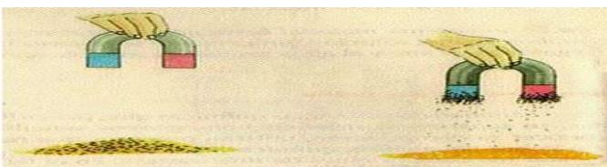
Consiste en separar con un imán los componentes de una mezcla heterogénea formada por un elemento metálico y otro no metálico. Por ejemplo, al acercar un imán a una mezcla de hierro y azufre, el hierro es atraído hacia el imán logrando separarse del azufre.
